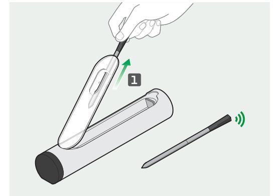
**4.** Abre el cargador y retira la sonda. Al retirar la sonda del cargador, el LED parpadea en verde indicando que el cargador está conectado a la sonda.
