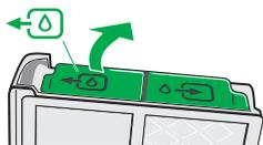
Le réservoir d'eau sale doit être vidé lorsque le niveau de remplissage maximal est atteint dans le réservoir d'eau sale. Videz le réservoir d'eau sale à chaque fois que vous sortez le réservoir.
