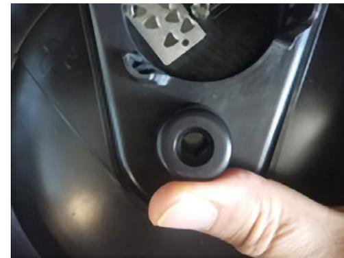
2 Pour démonter le boîtier, pousser le petit cylindre saillant vers l'extérieur avec le pouce. Ouvrir le boîtier en appuyant sur les deux languettes de la partie inférieure de façon à séparer les deux parties. Retirer disque.
