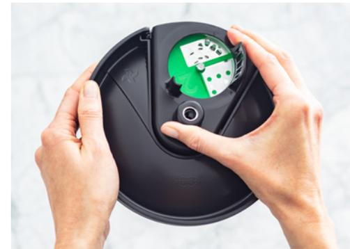
**2** Para desmontar el mecanismo, empuja hacia fuera con el pulgar el pequeño cilindro que sobresale. Abre el mecanismo presionando las dos pestañas de la carcasa superior para soltarla de la inferior. Retira la cuchilla.
