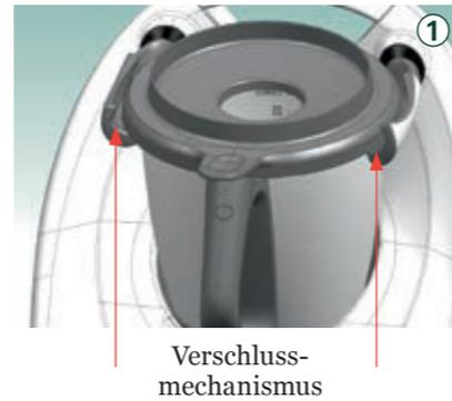
Im Kaltmixbetrieb wird die Drehzahl beim Mixen nach Ablauf der vorgewählten Zeit abgeschaltet und ein akustisches Signal zeigt das Ende des Arbeitsgangs und die Freigabe des Mixtopfdeckels an. Je nach der vorprogrammierten Geschwindigkeit gibt der Verschlussmechanismus den Mixtopfdeckel erst nach einigen Sekunden frei, um sicherzustellen, dass kein flüssiges Mixgut herauspritzen kann.
