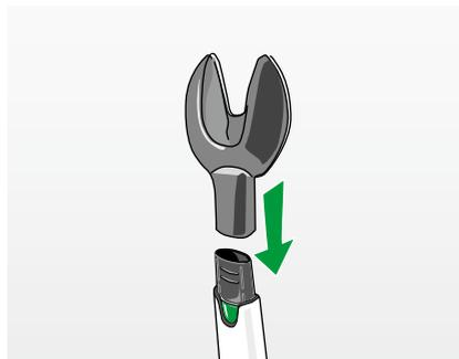
Durch die Saugkraft des Handstaubsaugers haftet der Bohraufsatz auf der Wand, wenn diese vollständig eben ist. So haben Sie die Hände frei, um das Loch zu bohren.
