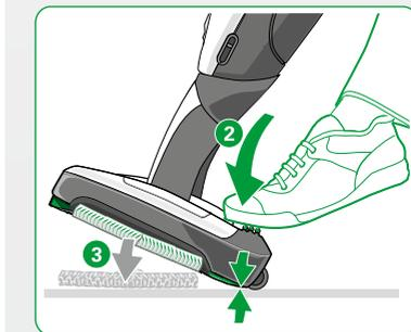
**i** El soporte del paño solo se podrá expulsar estando el aspirador Kobold de pie sobre sus ruedas en posición de descanso e inclinado hacia atrás.
